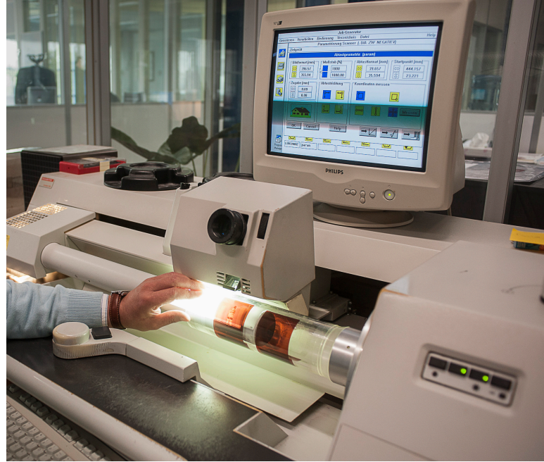
Een drumscanner, de lithograaf positioneert de originelen op de trommel, de drum, waar het apparaat de naam aan ontleent.
